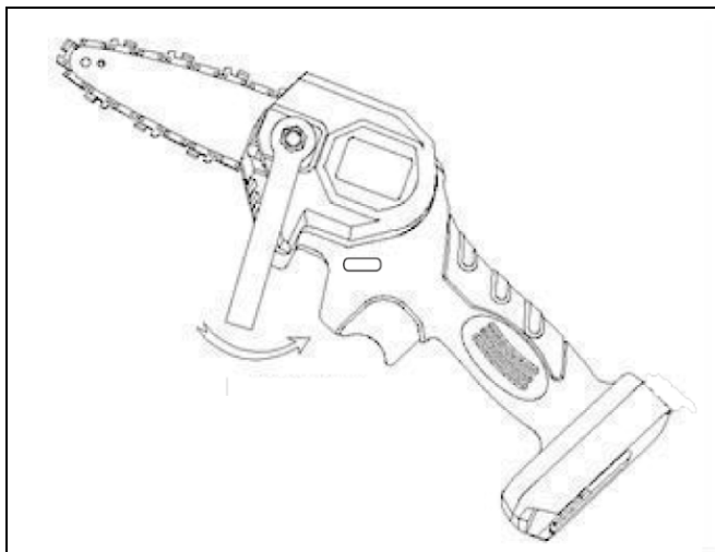
Рис. 1. Откручивание крепежного винта шины
