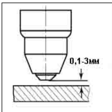
Рис. 10. Выбор расстояния от сопла плазмотрона до разрезаемого изделия
