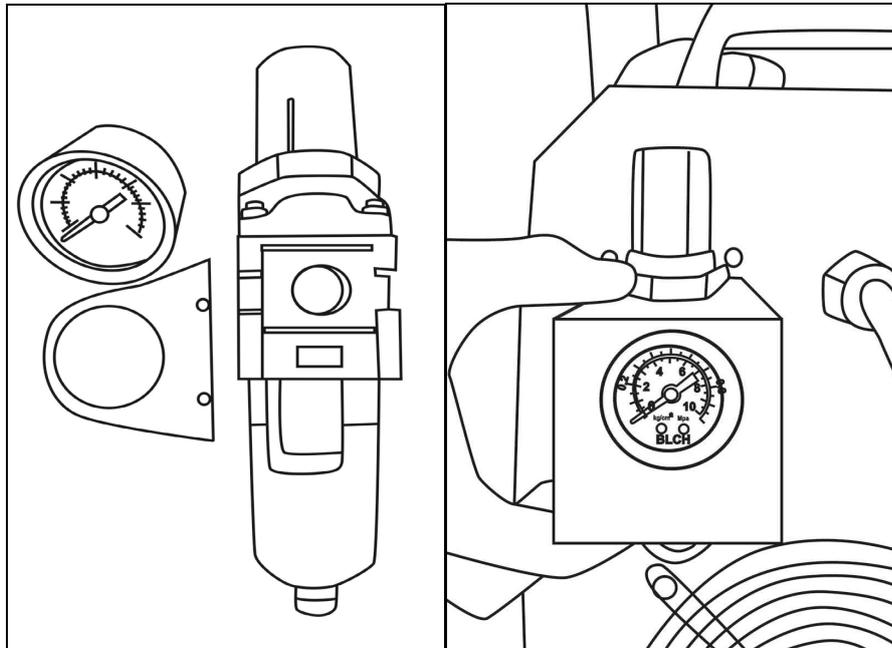
Рис.4. Сборка и установка фильтр-регулятора
