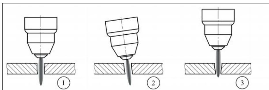
Рис. 12. Влияние угла наклона на качество реза.
