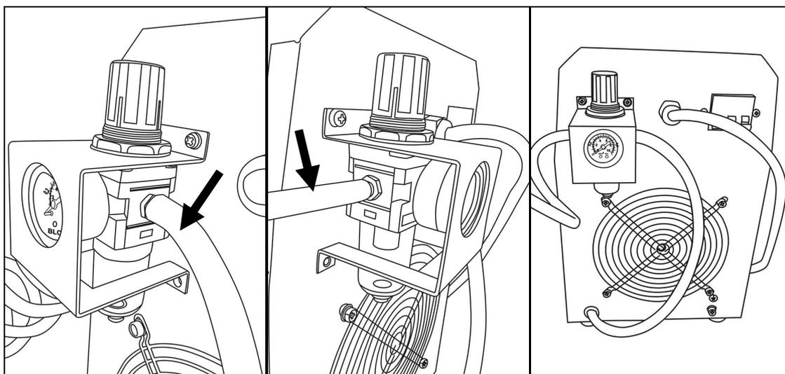
Рис.5. Подключение шлангов фильтр-регулятора (влажномаслоотделителя)
