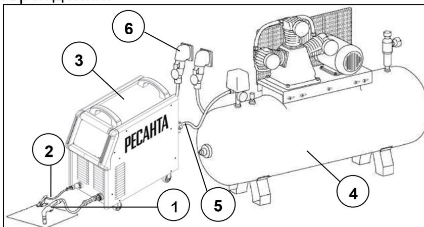
Рис. 3. Схема подключения аппарата воздушно-плазменной резки.
