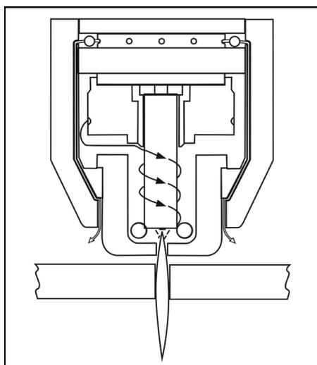
Рис. 8. Процесс плазмообразования
