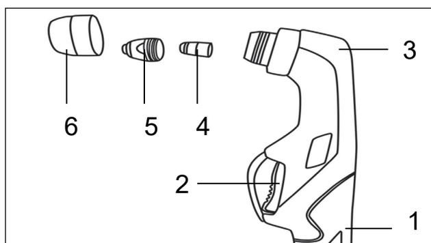
Рис. 16. Составные части горелки (плазмотрона)
